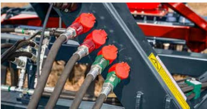
Für eine geordnete Aufbewahrung von Hydraulikschläuchen und Lichtenanlagenstecker gibt es eine Schlauchgarderobe. Alle Hydraulikschläuche sind serienmäßig mit Kennfix-Kupplungen ausgestattet.
