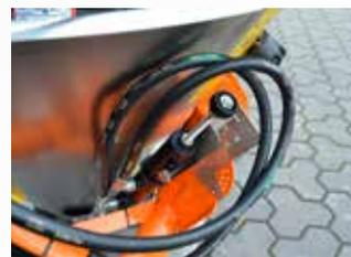
Hydraulische Schieberbetätigung (Option) für das bequeme Öffnen und Schließen der Auslässe aus der Kabine.
