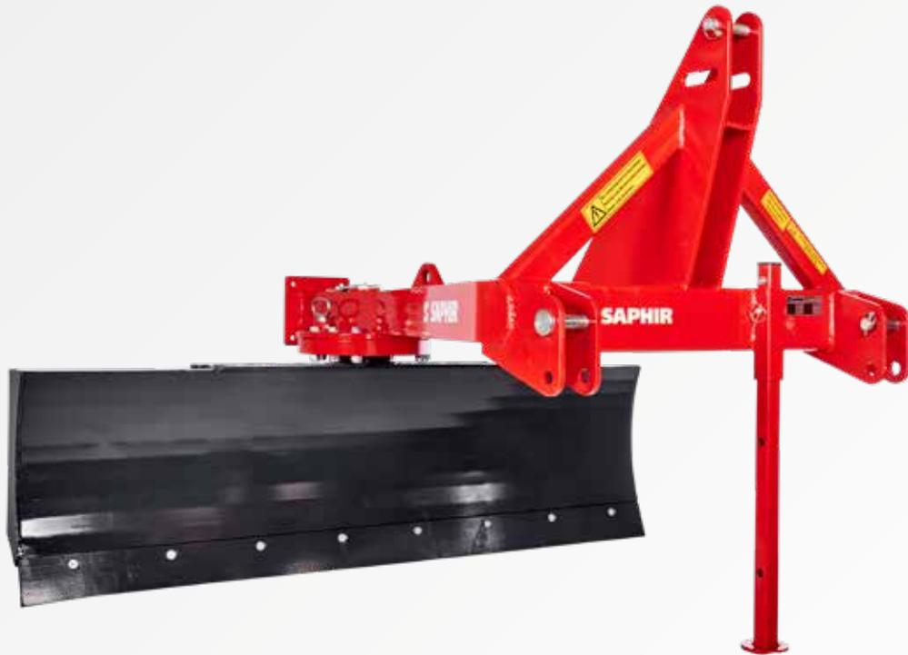
Die SAPHIR Planierschilder CONTOUR sind robuste, mechanisch verstellbare Schilder für leichte Planier- und Wegebauarbeiten mit Traktoren bis 73kW/100PS Leistung. Sie eignen sich außerdem für den Schneeräumeinsatz. Der Schildkörper kann serienmäßig um 360 Grad durchgeschwenkt werden. Somit kann das Schild auch im Frontanbau verwendet werden. Die Verriegelung erfolgt über einen Steckbolzen in Stufen von jeweils 22,5 Grad.
