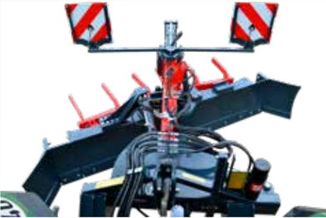
Die hydraulische horizontale Schildverstellung erfolgt über einen doppelwirkenden Zylinder. Der Schwenkbereich beträgt beidseitig ca. 35-55 Grad. Der Schwenkbereich kann stufenlos gewählt werden. Der Hydraulikzylinder ist zum Schutz der Schlepperhydraulik mit einem Sperrblock ausgerüstet.
