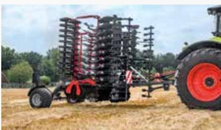
Die Seitenteile sind hydraulisch durch ein Sperrventil gegen unbeabsichtigtes Ausklappen gesichert. Die serienmäßige Beleuchtung sorgt für sicheren Straßentransport.
