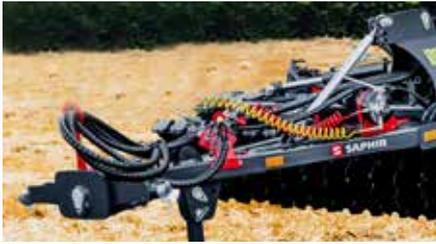
Die Maschine wird serienmäßig über eine Kat. III Aufnahme an den Schlepper angebaut. Mittels der Schlauchgarderobe werden alle Hydraulikschläuche, Druckluftschläuche und Beleuchtungskabel komfortabel verstaut.
