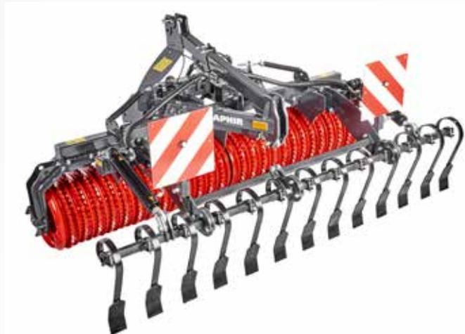
SAPHIR Cambridgewalze RollStar CB 301 mit hydraulischem Balance-Board und LED-Beleuchtungsanlage.
