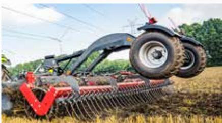
Schneller hydraulischer Aushub am Vorgewende und optional hydraulische Anpassung der Arbeitstiefe. Das Fahrwerk wird in Arbeitsstellung aus dem Bearbeitungshorizont geschwenkt.
