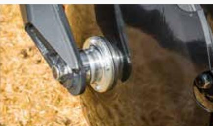
Geringer Verschleiß an den Scheiben durch geringe Kontaktflächen zum Boden und vollständigen Eigenantrieb der Scheibe. Es entsteht keine Reibung zwischen dem Scheibenrücken und dem Boden, wodurch der Verschleiß an der Scheibe minimiert wird. Die gezackten Hohl­scheiben mit einem Durchmesser von Ø 560 mm sind einzeln mit staubdichten und wartungsfreien Qualitätslagern montiert.
