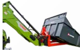
Der obere Zylinder sorgt für das Ausheben des Behälters aus der Grundposition
