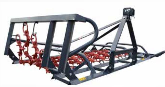
Die Grünlandegge Perfekt W ist in Arbeitsbreiten von 2,00 – 6,00 Metern verfügbar. Die Perfekt 200 W in starrer Ausführung. Ab Perfekt 300 W sind die Geräte für den Straßentransport einklappbar.
