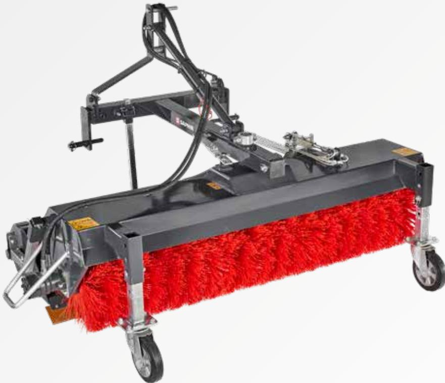
Die SAPHIR Kehrmaschinen FKM sind für den Einsatz mit landwirtschaftlichen Traktoren im Front- und Heckanbau (bei Frontanbau 3. Stützrad erforderlich) vorgesehen. Die mechanische Schwenkeinrichtung erlaubt ein Schrägstellen der Maschine. Somit kann die Maschine auch freikehend (ohne Sammelwanne) eingesetzt werden. Der Antrieb der Kehrwalze erfolgt über einen leistungsstarken Ölmotor, welcher über die Schlepperhydraulik angetrieben wird.
