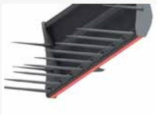
Zusätzliche Verschleißschiene zum Schutz des Zinkenträgerrohres
