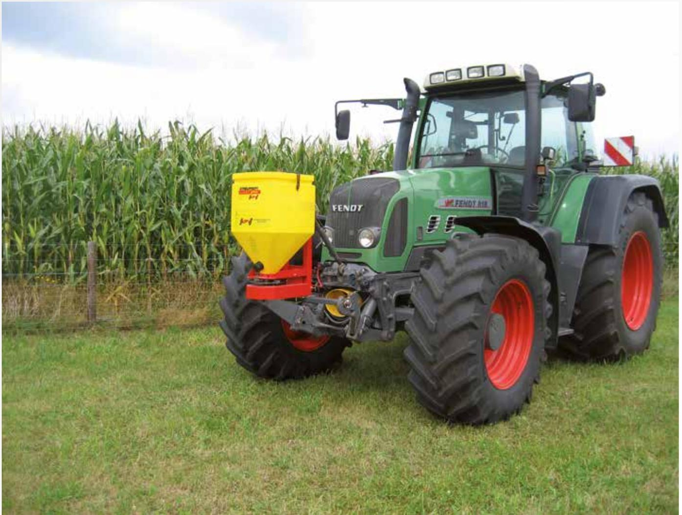
Der Universalstreuer SAPHIR UniSeed ist ideal für die Ausbringung von Zwischenfrüchten, Grassamen, Untersaaten, Schneckenkorn und ähnlichen Granulaten einsetzbar. Die Arbeitsbreite kann stufenlos den jeweiligen Erfordernissen angepasst werden. Ebenso ist die Saatstärke am Dosierschieber den pflanzenbaulichen Zielen entsprechend einstellbar.
