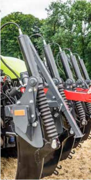
Hydraulische Steinsicherung der Zinken (Auslösekraft 650 kg). Nach dem Auslösen gehen die Zinken selbstständig in Arbeitsposition zurück.
