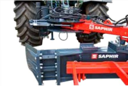
Die hydraulische Seitenverstellung erfolgt über einen doppelwirkenden Zylinder. Der Schwenkbereich beträgt 800 mm beidseitig (aus der Mitte) und kann stufenlos eingestellt werden. Der Hydraulikzylinder ist zum Schutz der Schlepperhydraulik mit einem Sperrblock ausgerüstet.
