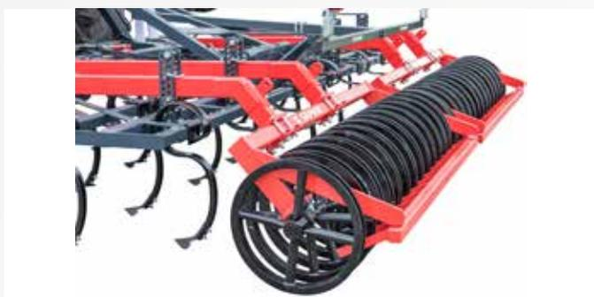
Die U-Profilringwalze bietet mit einem Durchmesser von  $\varnothing$  540 mm ein breites Einsatzspektrum und kann vielseitig eingesetzt werden.
