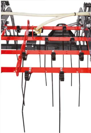
Die über Spindeln einstellbaren Zinkenfelder entfernen gemeinsame Rispe, Moos, abgestorbene Grasrückstände und weitere Unkräuter. Die mit 10 mm besonders starken Striegelzinken arbeiten hierbei besonders effektiv. Die vierreihig angeordneten Zinken haben eine Dreifachwindung.
