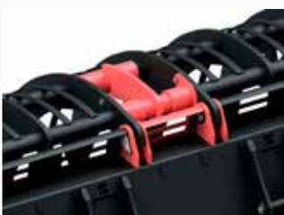
Obergreifer mit Mittellagerungen und austauschbaren Gleitlagern. Für Radlader mit Z-Kinematik ist serienmäßig eine herausnehmbare Aussparung integriert.
