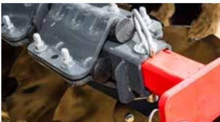
Bei den DiscStar Profi Modellen ist jede Scheibe einzeln über elastische Gummifeder­elemente gesichert. Dadurch kann sich jede Hohl­scheibe individuell der Bodenkontur anpassen, sodass Spuren nicht zugeschüttet, sondern uneingeschränkt bearbeitet werden. Weiterhin ermöglichen die Scheiben den größtmöglichen Durchgang bei großen Mengen organischer Masse im Vergleich zu paarweise angeordneten Scheiben.
