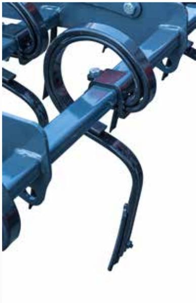
Der optionale Kombiflexzinken (32 x 12 mm) eignet sich für den Einsatz auf steinigem oder klutigen Böden. Aufgrund der steilen Zinkenstellung werden keine Ernterückstände, Steine oder Kluten an die Erdoberfläche befördert. Der vibrierende Zinken erzeugt im Saathorizont eine sehr feine Krümelstruktur ohne den Boden zu durchmischen. Dieser Zinken ist besonders verstopfungsunanfällig. Alle Zinken sind mit einer Doppelfeder ausgestattet.
