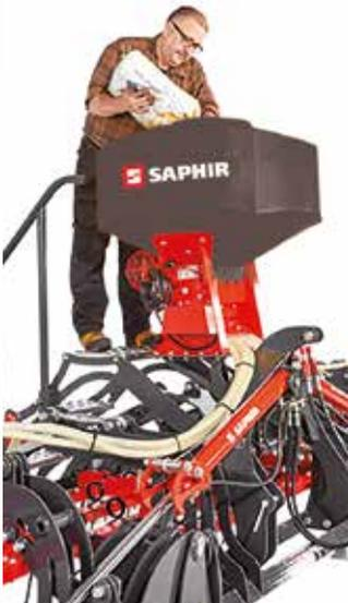
Optional ist das Gerät mit einem SAPHIR DrillStar ausrüstbar. Dieser ermöglicht eine sehr exakte und windunanfällige Nachsaat von Futtergräsern in geschädigten Beständen.
