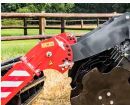
Werkzeuglose Verstellung der Arbeitstiefe durch Absteckbolzen. Optionale Ausstattung mit SAPHIR DrillStar möglich.
