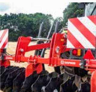
Optionale Beleuchtungsanlage inkl. Warntafeln für sicheren Straßentransport
