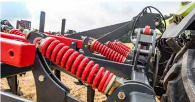
Bei steinigem oder harten Bodenverhältnissen empfiehlt sich eine automatische Steinsicherung (Modell TerraStar S Profi). Die Überlastsicherung erfolgt durch eine sehr stabile Druckfeder mit Schmiernippeln an den Drehpunkten. Die Zinken werden nach Überwinden des Hindernisses immer wieder in Arbeitsstellung zurückgestellt. Die Auslöskraft beträgt 500 kg.
