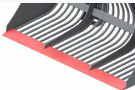
Bei Verladearbeiten auf befestigtem Untergrund empfehlen wird die SAPHIR Kartoffel- und Rübenkörbe mit einer hochverschleißfesten Schürfleiste 150x16 mm (500 HB) auszurüsten. Rundbügel sind zur Verladung auf unbefestigtem Untergrund (Feldmieten) geeignet.
