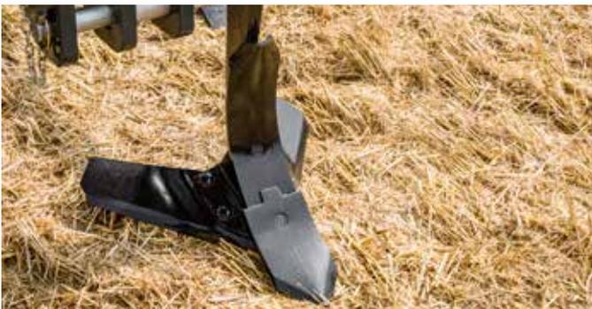
Alle Modelle sind serienmäßig mit Flügelscharen ausgerüstet. Die gekröpften Flügelscharen gewährleisten eine optimale Durchmischung des Bodens auch bei flacher Stoppelbearbeitung.
