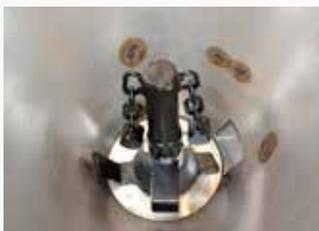
Steile Trichterwände aus Edelstahl sichern ein problemloses Nachrutschen des Streugutes. Das Rührwerk mit Kette sorgt für das Ausbringen von Salz bzw. Salz-Splittgemisch.
