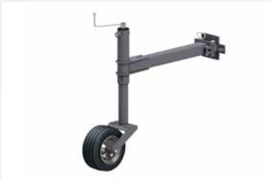
Durch den weit nach hinten versetzten Führungspunkt des Zentralstützrades (16x6.50-8) ist eine noch bessere Höhenführung des Schildes garantiert. Das Zentralrad kann stufenlos über eine Spindelverstellung eingestellt werden. Zum Transport wird es seitlich an den Schildkörper geschwenkt und arretiert.
