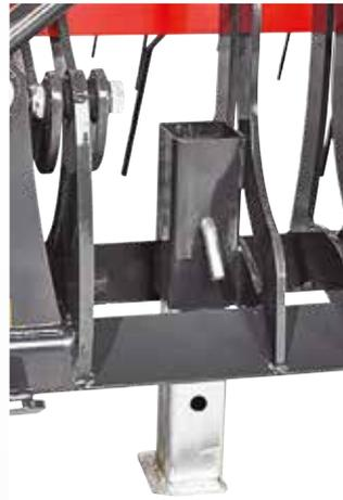
Die Winkeleisen des Rahmens sorgen für eine optimale Einebnung von Maulwurfshäufen. Gleichzeitig erfolgt eine Verteilung von Kuhfladen und organischen Rückständen.
