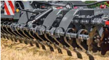
Das optionale Balance-Board sorgt für eine exakte Nivellierung des Bodens in der Saatbettbereitung. Weiterhin werden in der Stoppelbearbeitung Strohnester und Bodenunebenheiten verteilt.
