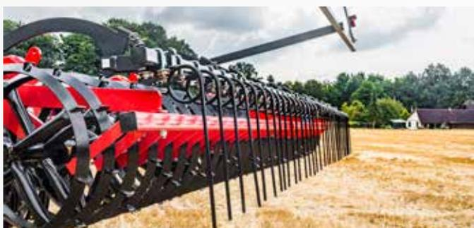
Der Nachstriegel dient der mechanischen Bekämpfung von Wurzelunkräutern.
