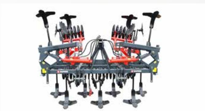
Bei den Modellen 501 Profi, 541 Profi, 501 S Profi werden die Seitenteile über zwei doppelwirkende Zylinder eingeklappt. Ein Sperrblock wirkt dem unbeabsichtigten Anheben der Seitenteile auch bei harten Bodenverhältnissen entgegen. Bei extremen Bodenverhältnissen können die Seitenteile zusätzlich durch einen Bolzen in Arbeitsstellung gesichert werden. Das Mittelteil kann eingeklappt auch zur Bearbeitung von Randstreifen verwendet werden.
