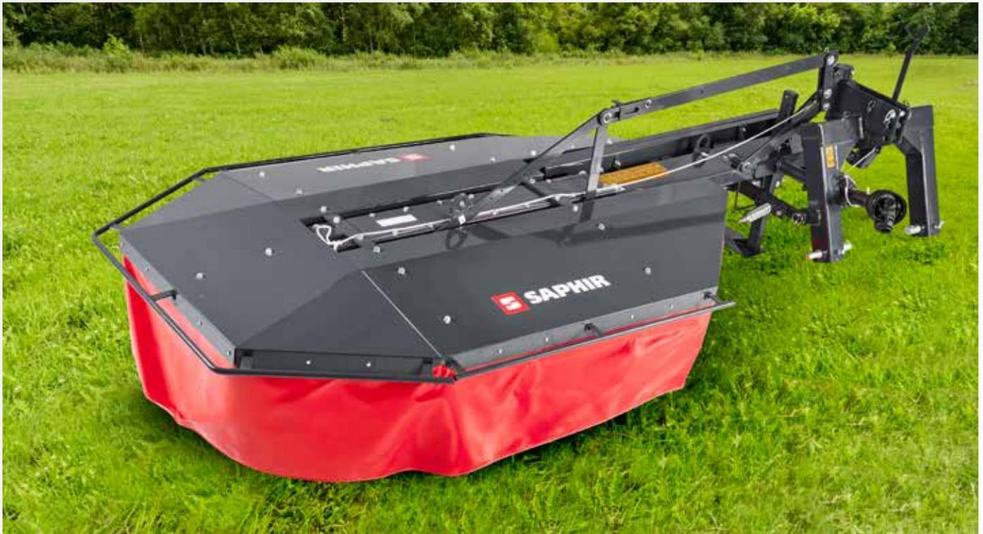
Die SAPHIR Kreiselmäher zeichnen sich durch robuste und bewährte Technik aus. Sie haben sich 1000-fach im Einsatz bewährt. Der starke verwindungssteife Getriebekasten ist das Herzstück aller SAPHIR Kreiselmäher. Die Mähtrommeln sorgen für ein sauberes Schneiden des Futters. Gute Boden Anpassung und geringes Eigengewicht sind weitere Vorteile dieser Geräte. Die förderaktiven Mähtrommeln leiten das Mähgut zügig weiter und legen es in sauberen Schwaden ab.
