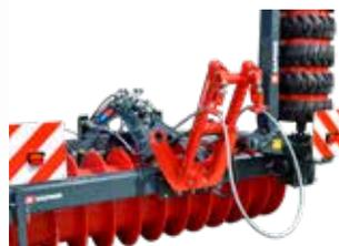
Optionale Schleppevorrichtung (1 x dw erforderlich) zur Schleppehilfe der Transportfahrzeuge für besonders hohe Fahrsilos
