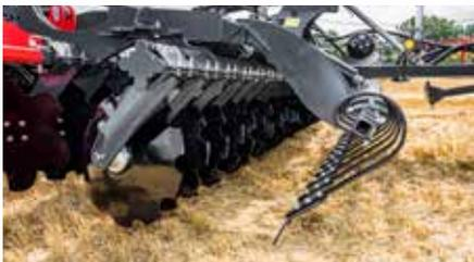
Die gezackten Hohl­scheiben mit einem Durchmesser von  $\varnothing$  560 mm sind an staubdichten und wartungsfreien Qualitätslagern montiert.
