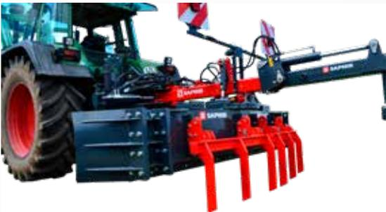
Mit dem Aufreißersatz kann im Wegebau zunächst der Untergrund aufgerissen werden (ca. 200mm). Im zweiten Arbeitsgang erfolgt dann die Planierarbeit mit hochgeschwenkten Aufreißern.
