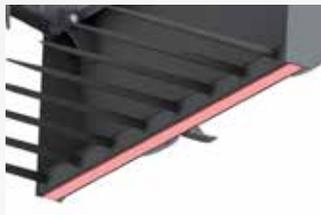
Zusätzliche Verschleißschiene zum Schutz des Zinktragrohres
