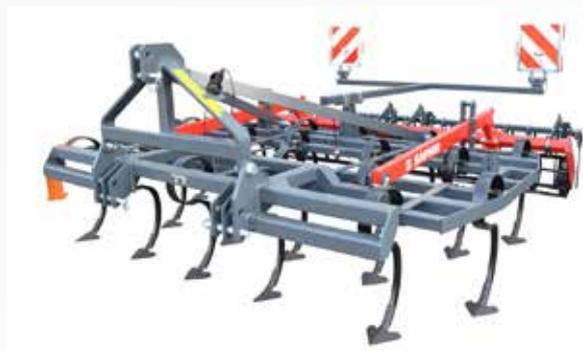
Das Modell AllStar 301 Profi hat einen durchgängigen Rahmen. Die zulässige Transportbreite von 3,0 m wird eingehalten. Das Gerät kann bereits mit Traktoren ab 44 kW / 60 PS betrieben werden. Durch die umfangreichen Sonderausrüstungen lässt sich das Gerät optimal an verschiedene Einsatzbereiche und Bodenbedingungen anpassen.
