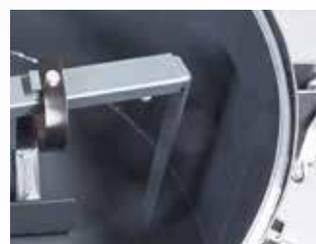
Nachstellbarer Seitenwandabstreifer zur restlosen Entleerung des Mischbehälters.
