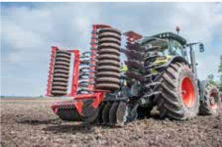
Der Rahmen ist bei Maschinen ab einer Arbeitsbreite von 4,0 m hydraulisch geklappt. Der dreiteilig aufgebaute Rahmen lässt sich zu einer Transportbreite von unter 3,00 Metern kompakt klappen bei zugleich geringer Transporthöhe.
