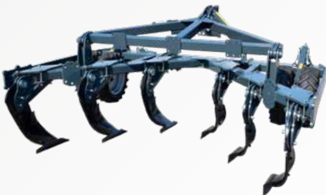
Der SAPHIR PlowStar H ist mit einer hydraulischen Steinsicherung ausgestattet. Bei Kollision mit einem Stein löst die Steinsicherung aus und der Zinken weicht aus. Nach Passieren des Hindernisses schwenkt der Zinken automatisch in die Arbeitsstellung zurück.
