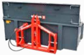
Der massive Anbaubock kombiniert die Aufnahme-möglichkeiten für Dreipunkt Kat. II, Euro und Gabelzinken (Tascheninnenmaß ca. 105 x 55) und eignet sich für den Front- und Heckanbau. Mit federbelasteten Bolzen kann die Heckklappe in 2 Positionen verriegelt werden.
