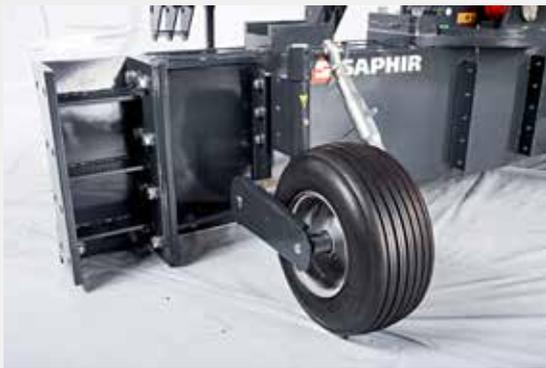
Die luftbereiften Stützräder (16x6.50-8) dienen der Höhenführung des Schildes. Die Höheneinstellung erfolgt über mechanische Drehspindeln.
