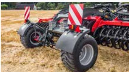
Das serienmäßige Fahrwerk mit Bereifung 500/50-17 und die Druckluftbremsanlage sorgen für sichere Straßenfahrten und eine hohe Aushubhöhe am Vorgewende.
