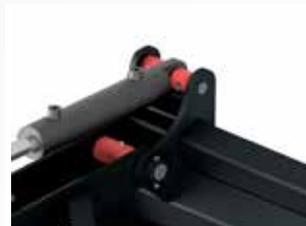
Wartungsarme, auswechselbare Gleitlager
