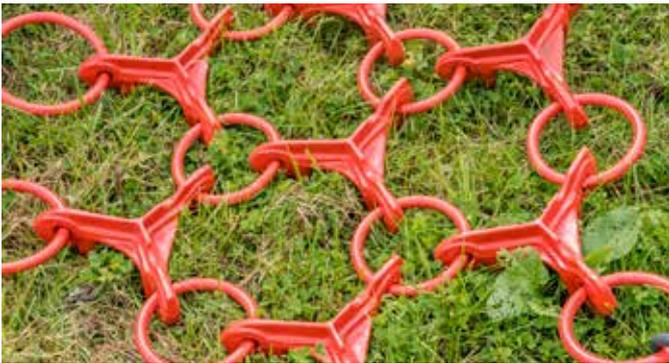
Das dreireihige Netz mit den ca. 2,5 kg schweren W-Gußsternen garantiert eine intensive Bearbeitung in nur einer Überfahrt. Die schweren W-Gußsterne können von beiden Seiten verwendet werden: Scharfes Eggen und Belüften mit der Zinkenseite, einfaches Schleppen zur Einebnung von Kuhfladen und Maulwurfshaufen mit der Glattseite.
