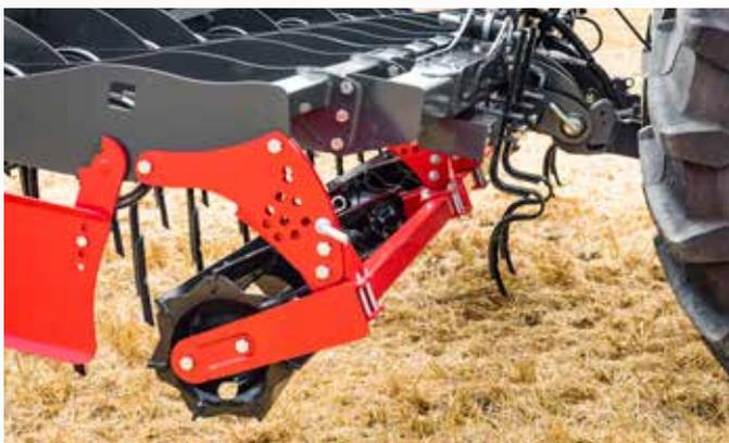
Vorlaufende Krümlerwalze 320 mm zur Einebnung des Bodens und Brechen größerer Kluten. In Kombination mit der nachlaufenden Walze dient sie zudem der gleichmäßigen Höhenführung des Gerätes. Alternativ kann ein mechanisches Balancerail für unebene Bodenstrukturen mit groben Kluten montiert werden.
