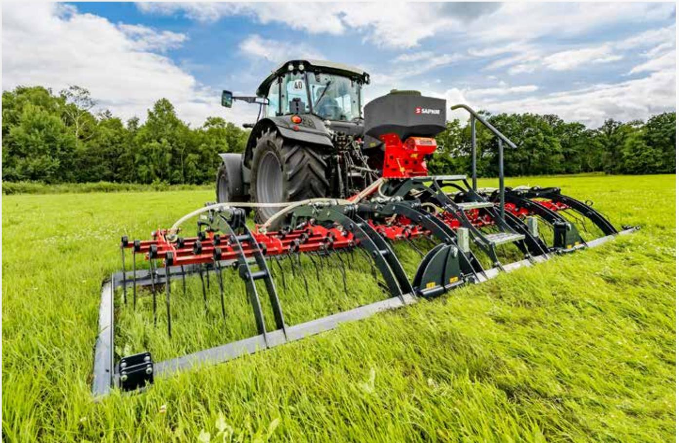
Mit dem pneumatischen SAPHIR Kleinsamenstreuer DrillStar und einem Grünlandstriegel / Bodenbearbeitungsgerät von SAPHIR kann in einem Arbeitsgang zeitsparend der Boden bearbeitet und zugleich gesät werden. Windunabhängige und punktgenaue Saatgutverteilung für gezielteren und besseren Erfolg. Durch seine elektrisch gesteuerte Säwelle, die den Saatgutstrom stufenlos reguliert, ist es möglich die gewünschte Menge jedes Streugutes auszubringen.
