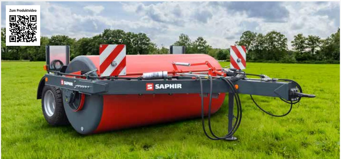
Die SAPHIR Wiesenwalze Robust FG ist mit einem zusätzlichen Fahrwerk ausgestattet. Die nah am Walzenkörper laufenden Räder vereinfachen den Straßentransport und ermöglichen einen komfortablen Feldwechsel. Optional kann die Walze mit einer 2-Kreis-Druckluftanlage ausgerüstet werden. Dies ermöglicht einen Straßentransport mit wasserbefülltem Walzenkörper.
