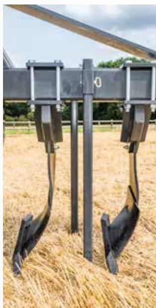
Die speziell geformten Schare heben den Unterboden an und lockern ihn dadurch auf der gesamten Arbeitsbreite. Anlagebleche und Scharspitzen können bei Verschleiß einzeln ausgetauscht werden.
