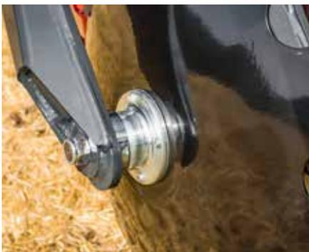
Wartungsfreie, staubdichte Lager mit besonders langer Lebensdauer.
