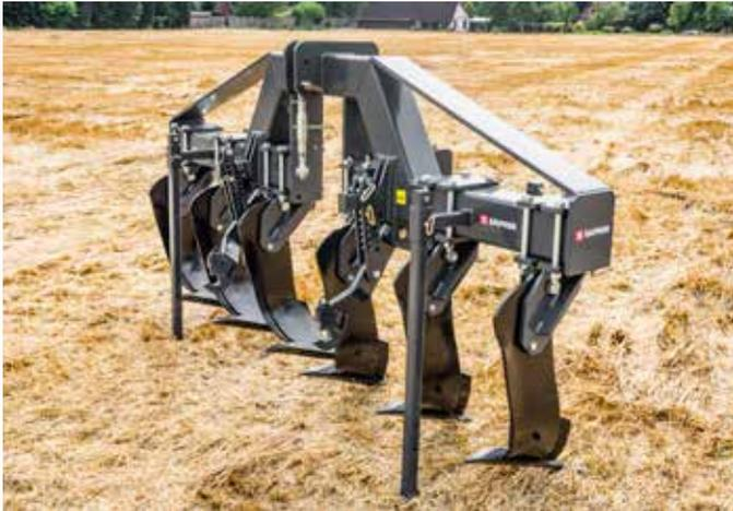
Die serienmäßige Steinsicherung mittels Abscherbolzen garantiert eine besonders lange Lebensdauer von Grindel und Rahmen. Im Heck der Maschine steht eine Dreipunktaufnahme Kat. II für die Kombination mit einem weiteren Anbaugerät zur Stoppel- oder Saatsbettbearbeitung (max. 1.600 kg) zur Verfügung.
