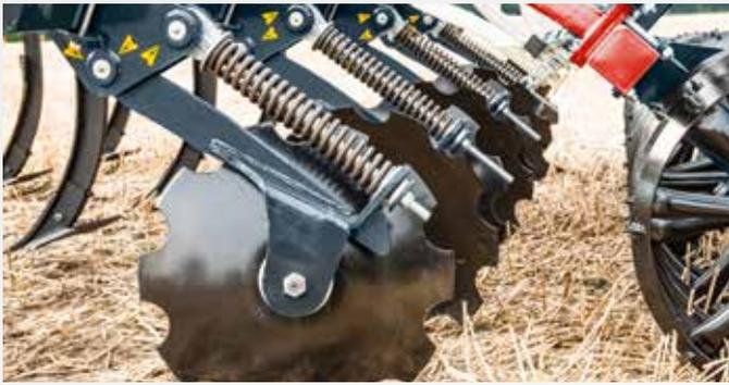
Die Einebnung von Unebenheiten und Einarbeitung von Ernterückständen erfolgt serienmäßig über Nivellatoren. Optional sind gefederte Hohlscheiben lieferbar, deren Lager dauerhaft geschmiert sind und keinerlei Wartung benötigen. Das Druckfedersystem schützt die Scheiben zusätzlich vor Überbeanspruchung und passt die Arbeitstiefe automatisch an die der Zinken an.
