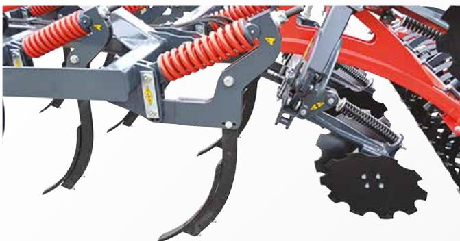
Bei besonders steinig und harten Verhältnissen empfiehlt sich eine automatische Steinsicherung. Die Auslösekraft der Druckfeder liegt bei über 550 kg, wodurch auch unter schwersten Bedingungen ein effizientes Arbeiten ermöglicht wird. Der Scharwinkel kann den Bodengegebenheiten angepasst werden. Je flacher der Winkel, desto intensiver ist der Mischeffekt.
