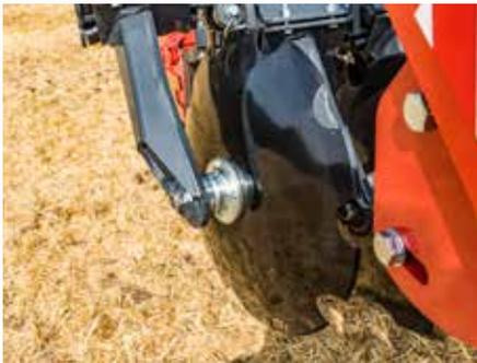
Die gezackten Hohl­scheiben mit einem Durchmesser von 560 mm sind an staubdichten und wartungsfreien Qualitätslagern mit einer besonders langen Lebensdauer montiert. Aufgrund der Scheibenstellung ohne Untergriff (Non-Angle) werden hohe Arbeitsqualitäten mit minimalem Scheibenverschleiß kombiniert.
