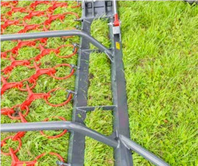
Die Grünlandeggen Perfekt W4 verfügen über zwei hintereinander angeordnete Winkelleisen in der Front der Maschine, welche für eine vollständige Zwangseinebnung von Unebenheiten und Maulwurfshäufen sorgen. Das reduziert den Verschleiß der darauffolgenden Erntetechnik und senkt die Grundfuttermverschmutzung.
