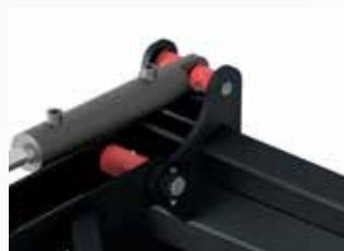
Wartungsarme, auswechselbare Gleitlager
