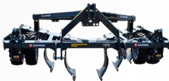
Serienmäßiger doppelt bereifter Stützrädersatz (185/65-15) zur gleichmäßigen Tiefenführung. Die Einstellung der Arbeitstiefe erfolgt komfortabel und stufenlos per Spindel.
