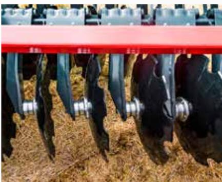
Die Non-Angle Scheibenstellung vermeidet das Aufschaukeln des Gerätes bei hohen Arbeitsgeschwindigkeiten und gewährleistet einen leichten Einzug auch bei trockenen Bodenverhältnissen. Die Maschinen sind leichtzügig.
