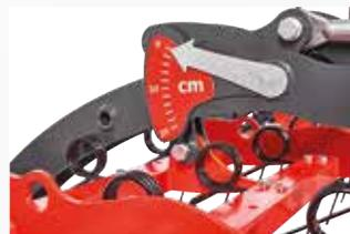
Die serienmäßigen Skalierungen an den Zinkenfeldern ermöglichen eine gleichmäßige Striegelintensität auf der gesamten Arbeitsbreite.
