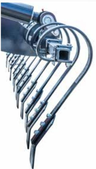
Option: Das hydraulische Balance-Board eignet sich hervorragend zur intensiven Einebnung des Saatbetts und ist insbesondere für leichte, schütffähige und steinige Böden geeignet. Auf besonders steinigen Böden drücken die Balance-Board-Schleppfedern die Steine in tiefere Bodenschichten.
