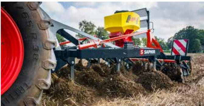
Die Überlastsicherung des Zinkens mittels Abscherbolzen ist für leicht schüttfähige Böden mit geringem Steinbesatz zu empfehlen. Der Scharwinkel kann den Bodengegebenheiten angepasst werden. Je steiler der Winkel, desto intensiver der Mischeffekt. In der flachsten Einstellung arbeitet die Scharspitze so tief wie das Flügelschar - es kann ab einer Arbeitstiefe von ca. 3 cm ganzflächig geschnitten werden.
