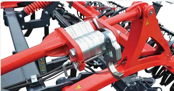
Die Arbeitstiefe des TineStar Profi wird über die mech. Tiefenverstellung eingestellt. Mittels Clips wird der nachlaufende Packer fest fixiert. So stützt sich der Grubber auf der Walze ab. Unter besonders trockenen und harten Bedingungen lässt sich das Gewicht der Nachlaufwalze auf den Grubberahmen verlagern. Statt der mech. Tiefenverstellung gibt es optional eine hydraulische Variante. Mit Hilfe von zwei Hydraulikzylindern kann die Arbeitstiefe bequem variiert werden.
