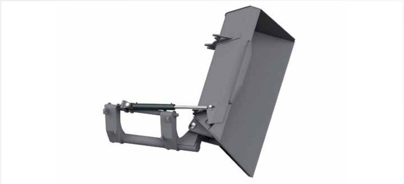
Die SAPHIR Seitenkippschaufel SKS ist ein spezielles Arbeitsgerät und findet hauptsächlich im Straßen- und Tiefbau Verwendung. Um z.B. den Seitenraum am Fahrbahnrand zu verfüllen, kann der Schaufelkörper seitlich in Fahrtrichtung nach rechts ausgekippt werden. Das Trägerfahrzeug muss dadurch weniger rangieren und steht im 90° Winkel zur Abladestelle. Die Schaufel ist geeignet für Schüttgewichte bis max. 1.300 kg/m<sup>3</sup>.
