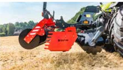
Der hohe Durchgang der Scheiben ermöglicht eine sehr kompakte Bauweise der Maschine. Dadurch können in der Dreipunkt getragene Kurzscheibeneggen mit hohen Arbeitsbreiten durch Schlepper geringerer Leistungsklassen gefahren werden. Die Vorderachsbelastung ist gering. Dadurch wird die Effizienz des Schleppers enorm gesteigert.
