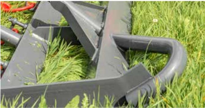
Die Grünlandeggen Perfekt S4 verfügen über zwei hintereinander angeordnete Winkelleisen in der Front der Maschine, welche für eine vollständige Zwangseinebnung von Unebenheiten und Maulwurfshaufen sorgen. Das reduziert den Verschleiß der darauffolgenden Erntetechnik und senkt die Grundfuttermverschmutzung.
