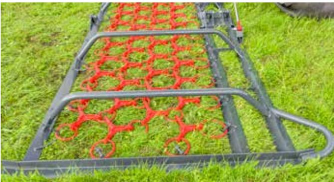
Die in vier Reihen angeordneten W-Gußelemente garantieren eine optimale Arbeitsleistung. Die Gußelemente sind beidseitig verwendbar: Zinkenseite für scharfes Eggen und Belüften der Grasnarbe, Glattseite zum Verteilen von Kuhfladen und Einebnen von Maulwurfshäufen.
